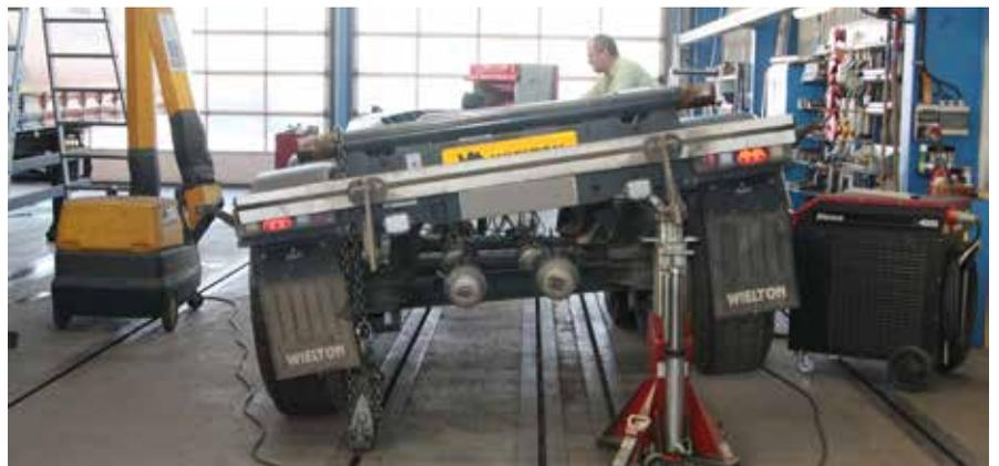
Aus schief mach gerade: auf der Richtbank werden Rahmen von Lkw und Anhängern nach Unfällen gerichtet.
