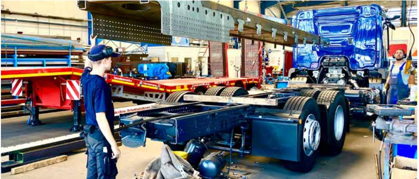
**Mitarbeiter setzen einen individuell gefertigten Hilfsrahmen auf das Lkw-Fahrgestell.**
