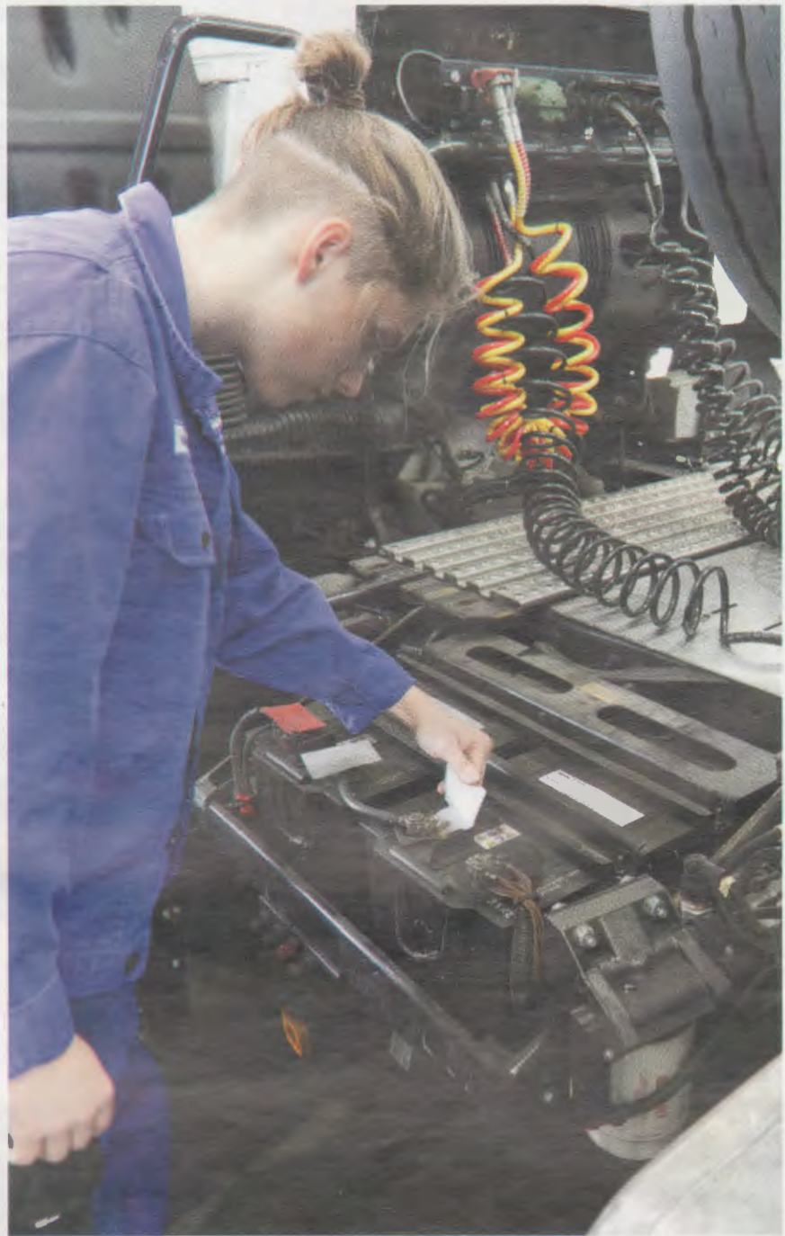
Batterien prüfen; falls möglich, Flüssigkeitsstand prüfen und mit destilliertem Wasser auffüllen.
