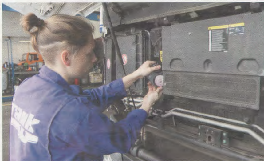
Kühlflüssigkeit spindeln, empfohlen wird eine 50/50-Mischung aus Wasser und Kühlerfrostschutz.
