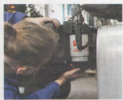
Wasser aus dem Wasserabscheider am Kraftstofffilter entfernen.
